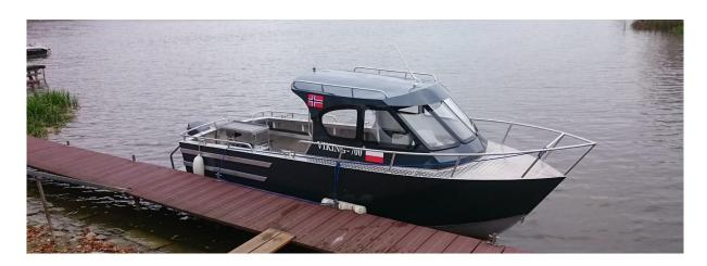
**ViKiNG 700** est un bateau de pêche côtière avec une longueur de coque de 765 cm. Il dispose d'une timonerie semi-ouverte avec une hauteur debout complète et d'un pont auto-videur. Il peut accueillir un maximum de 12 personnes et est équipé en standard de 4 sièges à l'intérieur de la timonerie et d'une cabine de toilette séparée. Le bateau est également disponible avec une cabine allongée pouvant accueillir 6 personnes ( modèle/version **ViKiNG 700 C** ).
